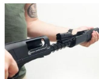
3. Segure o cano paralelamente ao tubo do depósito.
