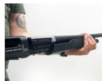
4. Insira a extremidade traseira do cano no receptáculo, alinhe a travessa com o tubo do depósito e empurre o cano para dentro do receptáculo até que encaixe perfeitamente.
