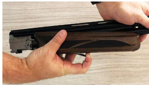
3. Empurre a alavanca superior para a direita. Encaixe o cano no receiver com cuidado.
